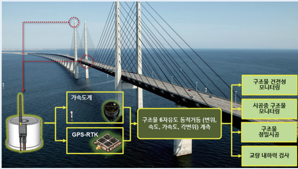
그림 1. 제안된 구조물 6자유도 동적거동 정밀계측 시스템 개요
