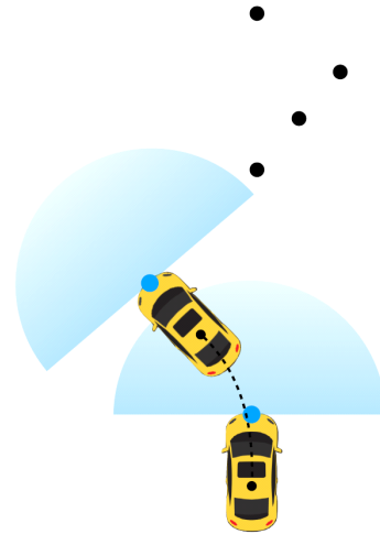
그림 1. 차량용 전방 관측 영상레이다의 운용상황 Fig. 1. Forward-looking imaging radar operation geometry with a vehicle.
