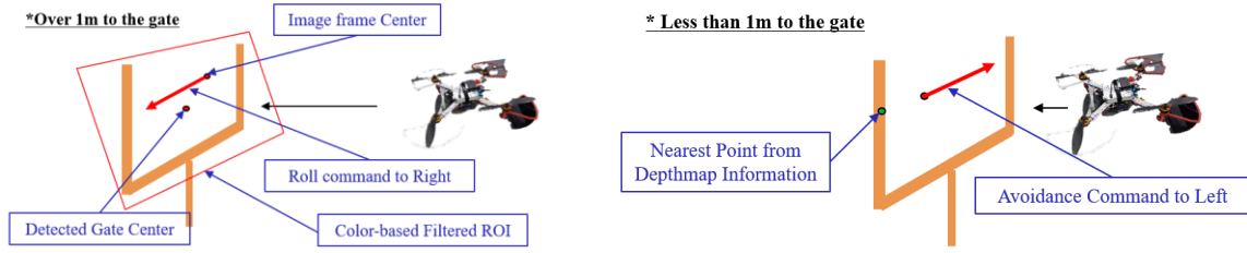
[그림 3] Depthmap-based Collision Avoidance Process
