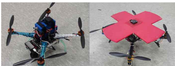
[그림 1] (좌)실험에 사용된 기체 (우)영상 표식을 설치한 추적대상기체
