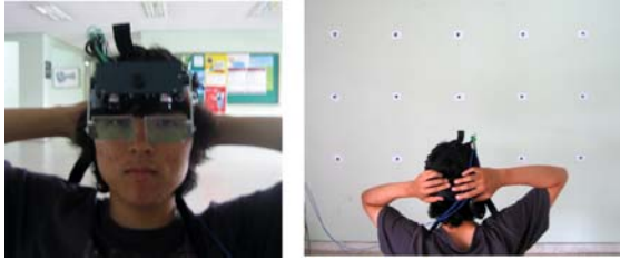
그림 11. 양안 아이트래커 시스템과 응시점 보정 실험
