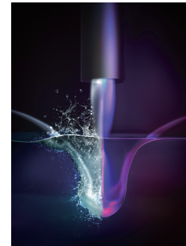
그림1. 기체 제트의 이온화를 통한 액체 표면의 안정화를 묘사한 실험
